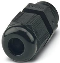
Presse-étoupe, matériau du raccordement vissé: PA, diamètre extérieur du câble 4 mm ... 8 mm, blindage: non, filetage de raccordement: M16 x 1,5, coloris: noir foncé RAL 9005
