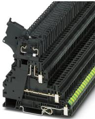
Bloc de jonction-fusibles, type de fusible: Verre / Céramique / ..., type de fusible: G / 5 x 20, tension nominale: 500 V, intensité nominale: 28 A, type de raccordement: Raccordement vissé, Section de référence: 4 mm<sup>2</sup>, section : 0,14 mm<sup>2</sup>- 6 mm<sup>2</sup>, type de raccordement: Raccordement vissé, Section de référence: 1 mm<sup>2</sup>, section : 0,14 mm<sup>2</sup>- 6 mm<sup>2</sup>, type de montage: NS 35/7,5, NS 35/15, coloris: noir
