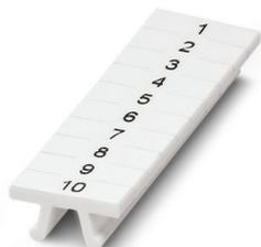
Ruban de repérage ZB, Rubans, blanc, repéré, impression transversale: numérotation continue 1 ... 10, 11 ... 20, etc. jusqu'à 91 ... 100, type de montage: encliquetage, pour bloc de jonction au pas de : 3,5 mm, surface utile: 3,5 x 10,5 mm, Nombre d'étiquettes: 10
