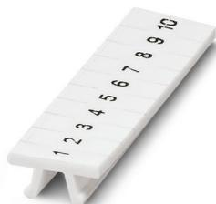
Ruban de repérage ZB, Rubans, blanc, repéré, impression longitudinale: numérotation continue 1 ... 10, 11 ... 20, etc. jusqu'à 91 ... 100, type de montage: encliquetage, pour bloc de jonction au pas de : 3,5 mm, surface utile: 3,5 x 10,5 mm, Nombre d'étiquettes: 10
