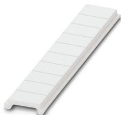
Ruban de repérage ZB, plat, à commander : par bandes, blanc, impression selon les indications du client, type de montage: encliquetage dans la rainure de repérage plate, pour bloc de jonction au pas de : 3,5 mm, surface utile: 3,5 x 5,2 mm, Nombre d'étiquettes: 10
