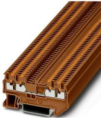
Blocs de jonction simple, tension nominale: 500 V, intensité nominale: 17,5 A, nombre de connexions: 4, type de raccordement: Raccordement Push-in, 1er étage, Section de référence: 1,5 mm<sup>2</sup>, section : 0,14 mm<sup>2</sup> - 1,5 mm<sup>2</sup>, type de montage: NS 35/7,5, NS 35/15, coloris: marron
