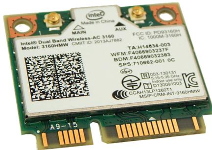
HMIYMINWIFI2 correspond à l'homologation IEEE 802.11ac/a/b/g/n MIMO 2 x 2 WLAN et Bluetooth.
