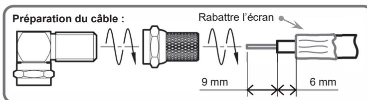
Câbler le répartiteur TV en **utilisant nécessairement des raccords coudés orientés vers le fond** du tableau pour permettre la fermeture du capot.
