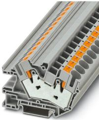
Bloc de jonction d'installation, tension nominale: 500 V, intensité nominale: 76 A, Raccordement Push-in, 1er étage, Section de référence: 16 mm<sup>2</sup>, section : 0,5 mm<sup>2</sup> - 16 mm<sup>2</sup>, type de montage: NS 35/7,5, NS 35/15, coloris: gris
