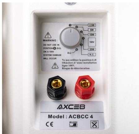
La puissance de l'enceinte est réglable depuis un sélecteur situé à l'arrière (2,5 / 5 / 10 / 20 W en 100 V ou 20 W en 8 Ohm).
