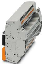
Connecteur de test, tension nominale: 400 V, nombre de connexions: 24, nombre de pôles: 12, type de raccordement: Raccordement Push-in, 1er étage, Section de référence: 6 mm<sup>2</sup>, section : 0,5 mm<sup>2</sup> - 10 mm<sup>2</sup>, type de montage: NS 35/7,5, NS 35/7,5, coloris: gris
