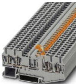
Bloc de jonction à couteau de sectionnement, Mode de raccordement: Raccordement à ressort, Section :0,08 mm<sup>2</sup> - 4 mm<sup>2</sup>, AWG: 28 - 12, Intensité nominale: 20 A, Tension nominale: 400 V, Longueur: 84 mm, Largeur: 5,2 mm, Coloris: gris, Montage: NS 35/7,5, NS 35/15
