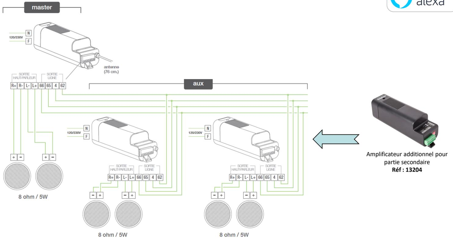
Le module MASTER possède une sortie ligne (AUX) permettant de connecter des amplificateurs.
