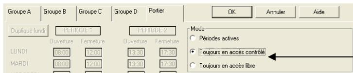
Le mode **toujours en accès contrôlé** est le plus utilisé car il offre le plus haut niveau de sécurité. Le relais 1 est activé (ouverture de la porte) si :
