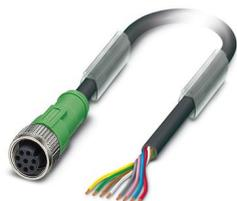
Câble pour capteurs/actionneurs, 8-pôles exempt d'halogène, extrémité libre, sur Connecteur femelle droit M12, détrompage: A, longueur de câble: 15 m
