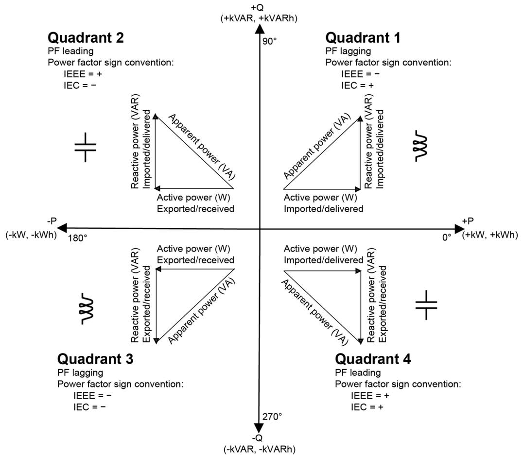
Las unidades de potencia de la potencia real P son vatios (W o kW), de la potencia reactiva Q son vares (VAR o kVAR) y de la potencia aparente S son voltamperios (VA o kVA).
