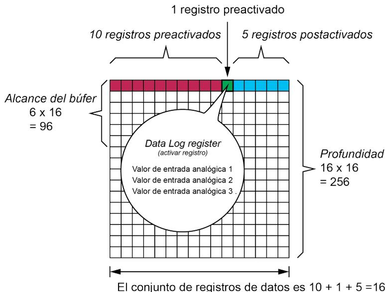
Conjunto de registro de datos = [registros previos a la activación] + [registros posteriores a la activación] + [registro de la activación real] = 10 + 5 + 1 = 16.
