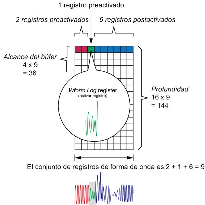
El conjunto de registro de forma de onda para la captura de forma de onda ampliada = [registros previos a la activación] + [registro real de activación] + [registros posteriores a la activación]. El total de registros de forma de onda capturados en este ejemplo es 2 + 1 + 6 = 9.
