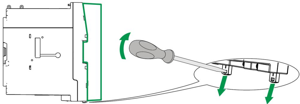
2. Sujetando la central de medida firmemente, hágala bascular hacia el exterior y tire de ella ligeramente hacia arriba para soltarla de los ganchos de retención superiores.
