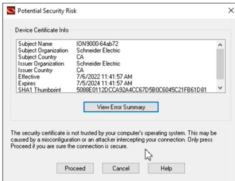
ION Setup almacena el certificado cuando se utiliza el modo de red. En el modo Single Device, debe aceptar el certificado cada vez que se conecte a un dispositivo mediante Secure ION.
