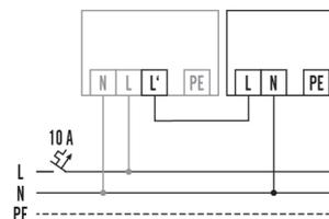
*Raccordement standard avec interrupteur*
