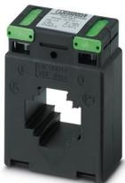
Transformateur de courant enfichable, courant primaire réglable de 50 à 750 A AC ; courant secondaire réglable sur 1 A AC ou 5 A AC ; classe de précision réglable sur 0,5 ou 1 ; puissance assignée réglable
