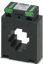
Transformateur de courant enfichable, courant primaire réglable de 75 à 1000 A AC ; courant secondaire réglable sur 1 A AC ou 5 A AC ; classe de précision réglable sur 0,5 ou 1 ; puissance assignée réglable
