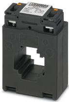
Transformateur de courant enfichable à raccordement vissé ou Push-in, raccordement du conducteur directement par le haut avec Push-in, aucun outil nécessaire. Sélections possibles : courant primaire (50 ... 750) A AC, courant alternatif (1 ou 5) A AC, classe de précision 0,5 ou 1, puissance VA
