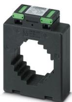
Transformateur de courant enfichable, courant primaire réglable de 200 ... 1250 A AC ; courant secondaire réglable sur 1 A AC ou 5 A AC ; classe de précision réglable sur 0,5 ou 1 ; puissance assignée réglable
