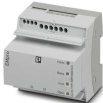
Centrale de mesure d'énergie multifonction sans écran avec interfaces Ethernet et CLOUD intégrées pour la mesure des paramètres électriques dans les installations à basse tension jusqu'à 690 V. ([phoenixcontact.com/empro-help](https://www.phoenixcontact.com/empro-help))
