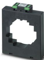
Transformateur de courant enfichable, courant primaire réglable de 800 ... 4000 A AC; courant secondaire réglable sur 1 A AC ou 5 A AC ; classe de précision réglable sur 0,5 ou 1 ; puissance assignée réglable
