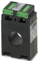
Transformateur de courant à canon, courant primaire réglable de 50 à 500 A AC ; courant secondaire réglable sur 1 A AC ou 5 A AC ; classe de précision réglable sur 0,5 ou 1 ; puissance assignée réglable
