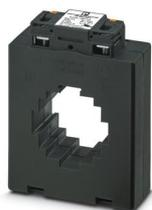
Transformateur de courant enfichable à raccordement vissé ou Push-in, raccordement du conducteur directement par le haut avec Push-in, aucun outil nécessaire. Sélections possibles : courant primaire (100 ... 1 500) A AC, courant alternatif (1 ou 5) A AC, classe de précision 0,5 ou 1, puissance VA
