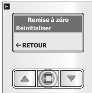
Se servir des boutons ▲▼ pour saisir le premier chiffre de l'ancien mot de passe puis appuyer sur le bouton □ pour confirmer et passer au chiffre suivant.
