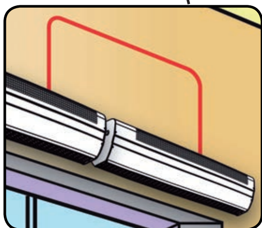
Liaison par 1 fil entre les appareils
