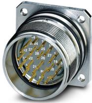
Connecteur d'appareil face arrière, droit, Verrouillage à vis, M27, nombre de pôles: 26, type de contact: Mâle, Joint torique radial, 4xM3, blindé: oui, indice de protection: IP67, nombre de pôles: 26, type de raccordement: Raccordement à sertir, série: HC
