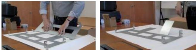
Monter les 4 vis sur les deux ventilateurs. Fixer le support en respectant le sens de l'air marqué sur le ventilateur et la flèche du même support.
