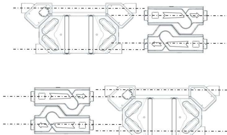
Monter les 4 vis sur les deux ventilateurs. Fixer le support en respectant le sens de l'air marqué sur le ventilateur et la flèche du même support.
