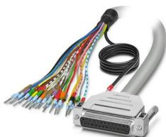
Câble rond blindé préconfectionné; raccordement 1 : Fils individuels (25-pôles) (Les fils sont repérés et équipés d'embouts. La tresse de blindage sort d'une extrémité de câble distincte.); raccordement 2 : Connecteur femelle D-SUB (1x 25-pôles); longueur de câble: 2 m
