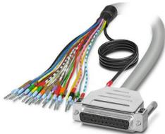
Câble rond blindé préconfectionné; raccordement 1 : Fils individuels (25-pôles) (Les fils sont repérés et équipés d'embouts. La tresse de blindage sort d'une extrémité de câble distincte.); raccordement 2 : Connecteur femelle D-SUB (1x 25-pôles); longueur de câble: 15 m
