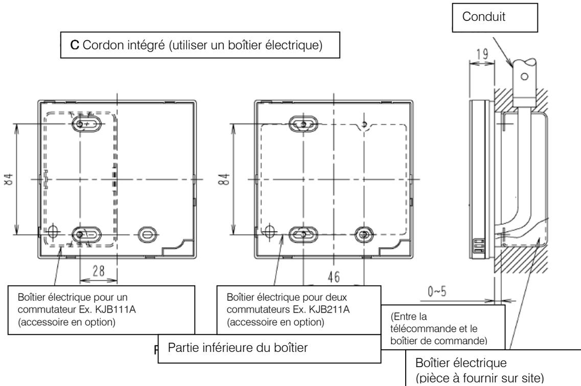
En cas d'utilisation d'un boîtier électrique : relier la masse du faisceau de câblage BRCW901A\* à la partie métallique du boîtier électrique.
