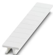
Ruban de repérage ZB, à commander : par bandes, blanc, impression selon les indications du client, type de montage: encliquetage dans la rainure de repérage élevée, pour bloc de jonction au pas de : 5,2 mm, surface utile: 5,15 x 10,5 mm, Nombre d'étiquettes: 10
