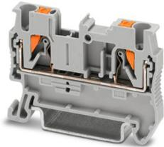
Blocs de jonction simple, tension nominale: 800 V, intensité nominale: 24 A, nombre de connexions: 2, nombre de pôles: 1, type de raccordement: Raccordement Push-in, Section de référence: 2,5 mm<sup>2</sup>, section : 0,14 mm<sup>2</sup> - 4 mm<sup>2</sup>, type de montage: NS 35/7,5, NS 35/15, coloris: gris
