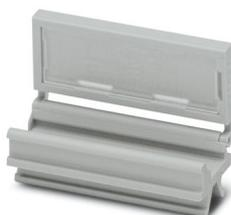
Etiquette de repérage de groupes de blocs de jonction, s'encliquette au centre des blocs de jonction à vis, à ressort ou à raccordement rapide, repérage avec ruban enfichable ESL 26 x 6 mm ou EST 25 x 6 mm, au niveau du pied avec un repérage ZB, longueur : 29 mm
