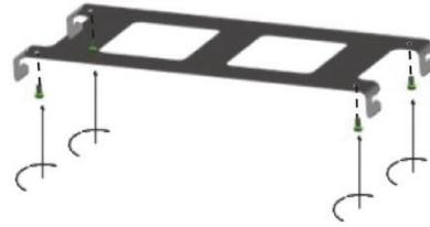
3. Positionner la DECO FLAT DHU sur la platine et insérer latéralement les quatre vis-support dans les logements de la platine. Serrer les quatre vis-support.
