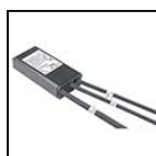
S.2411 ALIMENTATION ELECTRONIQUE 0/1-10V 230V/700mA 17W o 230V/24V 15W IP68 230V/700mA Puissance maximale installable: 17W ou 230V/24V Frequency PWM : 240Hz Puissance maximale installable: 15W Dimensions 121mmx53mmx26mm IP68 SELV CLASS II L'UTILISATION DU DÉCHARGEUR À SURTENSION S.2499 EST RECOMMANDÉE POUR CHAQUE BALLAST ÉLECTRONIQUE QUI DOIT ÊTRE INSTALLÉ À UNE DISTANCE MAXIMALE DE 10m DE CELUI-CI.
