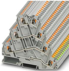
Bloc moteur, quatre étages, connectique : raccordement Push-in, section : 0,2 mm<sup>2</sup> - 6 mm<sup>2</sup>, AWG : 24 - 10, largeur : 6,2 mm, hauteur : 95,4 mm, coloris : gris, type de montage : NS 35/7,5, NS 35/15
