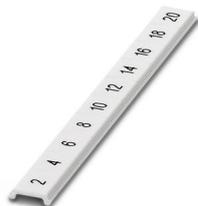
Ruban de repérage ZB, plat, Rubans, blanc, repéré, impression longitudinale: nombres pairs croissants 2 ... 20, 22 ... 40, etc. jusqu'à 82 ... 100, type de montage: encliquetage, pour bloc de jonction au pas de : 6,2 mm, surface utile: 5,15 x 6,15 mm, Nombre d'étiquettes: 10
