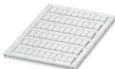
Repères pour blocs de jonction, à commander : sous forme de planche, blanc, impression selon les indications du client, type de montage: encliquetage dans la rainure de repérage élevée, pour bloc de jonction au pas de : 6,2 mm, surface utile: 5,6 x 10,5 mm, Nombre d'étiquettes: 60
