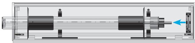
**5** Sortir l'axe existant en rétractant l'embout opposé au treuil, tirer vers soi la partie treuil, puis sortir l'axe du coffre.
