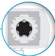
**16** Présenter la tête moteur face au support et passer le câble moteur dans le trou de perçage.
