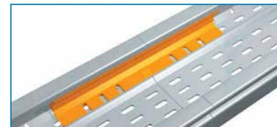
Un système astucieux de repères permet d'installer les éclisses en fonction des écarts de température maximum (20, 40 ou 60 °C) afin de permettre la dilatation des chemins de câbles.
