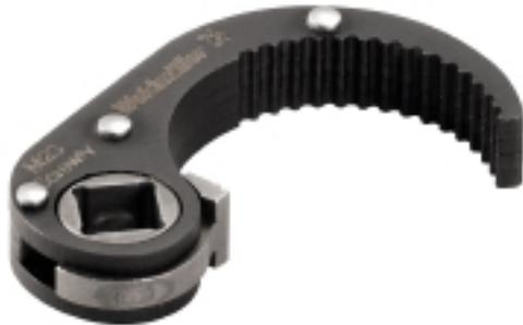
Les accessoires Screwty® sont indiqués pour les connecteurs débrochables ronds M23 à équiper et moulés, avec une dimension extérieure du moletage de  $26,2 \pm 0,3$  mm. Le couple de raccordement est de 2-2,5 Nm.
