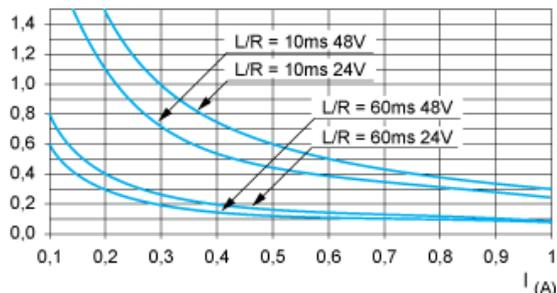
DC13 commutation des électroaimants,  $L/R \leq 2 \times (U_e \times I_e)$  en ms,  $U_e$  : tension nominale de fonctionnement,  $I_e$  : courant nominal de fonctionnement (avec une diode de protection sur la charge, les courbes DC12 doivent être utilisées avec un coefficient de 0,9 appliqué au nombre en millions de cycles de fonctionnement)
