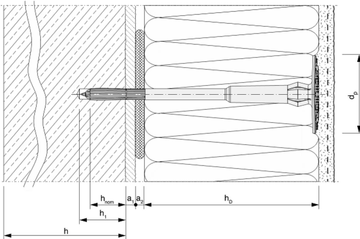
$h_{nom}$  = profondeur d'ancrage totale de la cheville en plastique dans le matériau support
