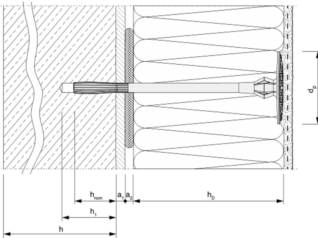
$h_{nom}$  = profondeur d'ancrage totale de la cheville en plastique dans le matériau support
