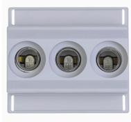
**Socle pour fusible, Basse tension, 16 A, AC 400 V, D01, 3P, IEC, montage sur barre DIN, pour 2 fils de connexion de 1,5 à 4 mm**
