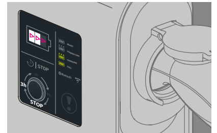
Borne en attente de départ différé (défilement blanc) Voyants "3h" (ou 6h ou 9h) et stop allumés (blanc fixe) Charging station awaiting delayed start (white scrolling) "3h" (or 6h or 9h) and stop indicator lights on (steady white)
