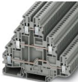
Bloc de jonction à plusieurs étages, Mode de raccordement: Raccordement vissé, Section : 0,14 mm<sup>2</sup> - 4 mm<sup>2</sup>, AWG: 26 - 12, Largeur: 5,2 mm, Coloris: gris, Type de montage: NS 35/7,5, NS 35/15
