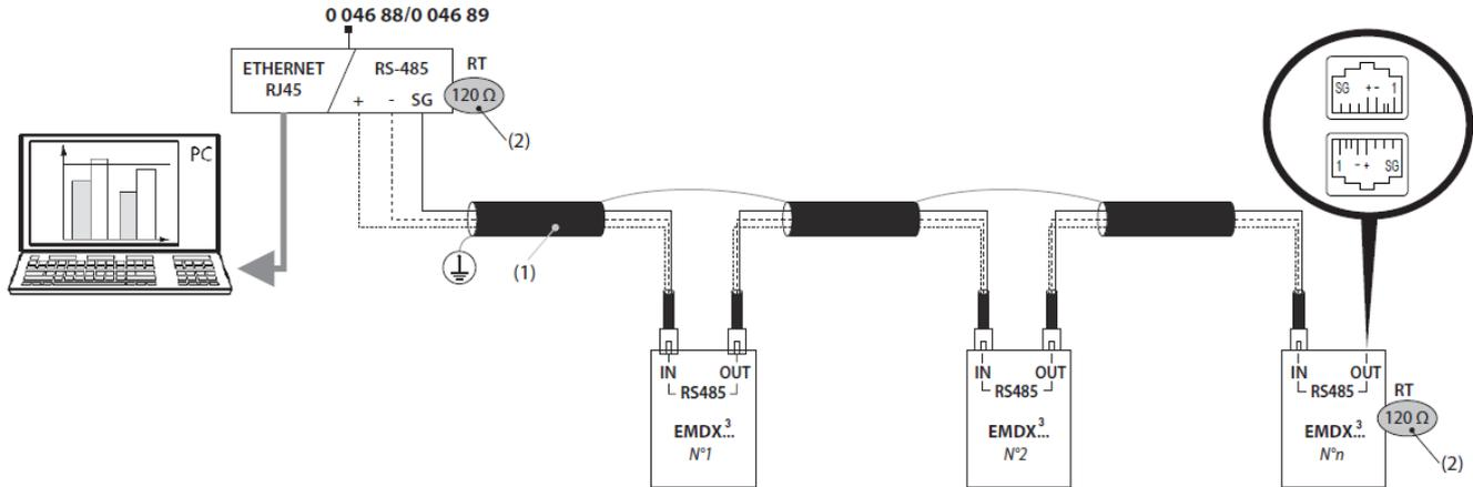
**Schéma de branchement RS485 Modbus avec Mini Web Serveur:**
