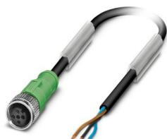
Câble pour capteurs/actionneurs, 3-pôles, PUR exempt d'halogène, gris-noir RAL 7021, extrémité libre, sur Connecteur femelle droit M12, détrompage: A, longueur de câble: 0,5 m, extrémité libre de 150 mm
