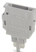
Fiches de composants, pour le montage de composants à choisir soi-même, tension nominale: 250 V, intensité nominale: 6 A, type de raccordement: Raccord enfichable, pas: 5,2 mm, largeur: 5,1 mm, hauteur: 24,2 mm, nombre de pôles: 1, coloris: gris, type de montage: Enfichable (fente)
