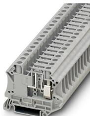
Bloc de jonction à fonction, L'intensité et la tension sont fonction de la fiche utilisée., avec vis à alvéole pour la réception des points test, tension nominale: 500 V, intensité nominale: 20 A, type de raccordement: Raccordement vissé, Section de référence: 2,5 mm<sup>2</sup>, section : 0,2 mm<sup>2</sup> - 10 mm<sup>2</sup>, montage: NS 35/7,5, NS 35/15, coloris: gris
