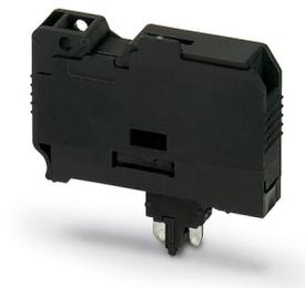
Fiche porte-fusible, Retirer la fiche porte-fusible du module de base avant de remplacer le fusible., intensité nominale: 10 A, type de fusible: G / 6,3 x 32, coloris: noir
