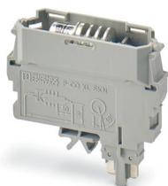
Fiches de composants, spécifique pour recevoir la diode SKN 2,5, tension nominale: 400 V, intensité nominale: 10 A, type de raccordement: Raccord enfichable, largeur: 12,3 mm, hauteur: 41,2 mm, nombre de pôles: 1, coloris: gris, type de montage: Enfichable (fente)
