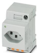
Prise de courant, Modèle d'enfichage e type J, Raccordement à ressort Push-in, avec témoin lumineux, pour la Suisse et autres pays, gris, pour montage sur profilé dans une interface de service ou pour montage direct, 250 V AC, 16 A, -20 °C, 60 °C, SEV 1011
