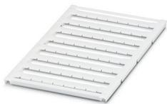
Repères pour blocs de jonction, Planche, blanc, vierge, repérable avec : BLUEMARK ID COLOR, BLUEMARK ID, BLUEMARK CLED, PLOTMARK, CMS-P1-PLOTTER, type de montage: encliquetage, pour bloc de jonction au pas de : 8,2 mm, surface utile: 7,6 x 5,1 mm, Nombre d'étiquettes: 56
