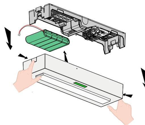
Les accumulateurs doivent être remplacés lorsque le bloc autonome ne satisfait plus à sa durée assignée de fonctionnement.
