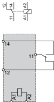
NOTE : Pour l'entrée CC, A1 doit être +, sinon court-circuit du module de protection
