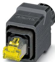
Connecteur RJ45, indice de protection: IP65/IP67, nombre de pôles: 8, 10 Gbit/s, CAT6<sub>A</sub>, matériau: Plastique, type de raccordement: Raccordement à sertir, section raccordable: AWG 27- 24, sortie du câble: droit, coloris: noir, Ethernet
