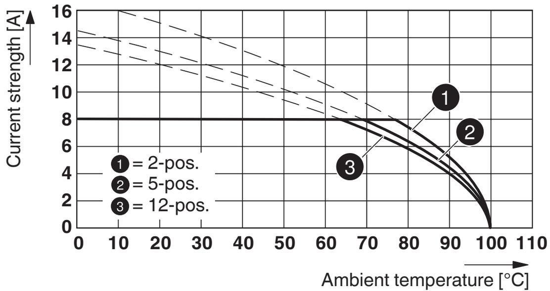
Type : FMC 1,5/...-ST-3,5-RF avec IFMC 1,5/...-ST-3,5-RN
