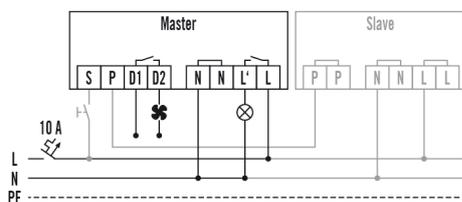
Raccordement maître/esclave avec commande optionnelle par poussoir. Un appareil maître peut être raccordé à 10 appareils esclaves au maximum.
