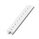
Ruban de repérage ZB, Rubans, blanc, repéré, repérable avec : CMS-P1-PLOTTER, impression transversale: numérotation continue 1 ... 10, 11 ... 20, etc. jusqu'à 91 ... 100, type de montage: encliquetage, pour bloc de jonction au pas de : 8,2 mm, surface utile:  $10,5 \times 8,15 \text{ mm}$ , Nombre d'étiquettes: 10
