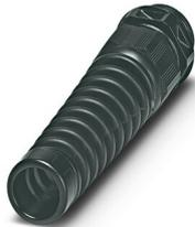
Presse-étoupe, matériau du raccordement vissé: PA, diamètre extérieur du câble 9 mm ... 17 mm, blindage: non, filetage de raccordement: M25 x 1,5, coloris: noir foncé RAL 9005, avec protection anti-courbure
