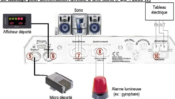
Schéma de câblage pour alimentation directe d'une sono ( P_{max} \leq 2000 \text{ W} )
