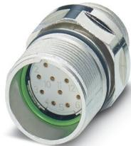
M23, Embases paroi avant, série: CA, droit, blindé: oui, Pour verrouillage standard et SPEEDCON, Nombre de pôles: 17, Sens de rotation: standard, type de contact: Connecteur femelle, Raccordement à sertir, Joint axial, Fixation centrale M20 x 1,5, à positionner via un écrou de sécurité, détrompage: N
