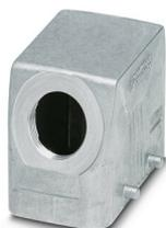
Capot passe-câble B10, pour étrier transversal, matériau: Aluminium coulé sous pression, résistant à l'eau de mer, nombre de sorties: 1, latérale, 1x M20, hauteur: 57 mm, presse-étoupe: sans, Standard
