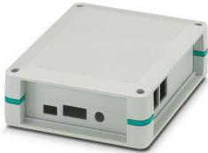
Boîtier complet pour circuits imprimés. Inclut des demi-coques de boîtiers, des parois avec ouvertures pour les principaux raccordements, support autocollant pour fixer un nano-ordinateur Raspberry Pi Model B2 et B3, des vis pour boîtier et fixation du circuit imprimé ; boîtier de couleur gris clair avec inserts de montants d'angle bleu turquoise
