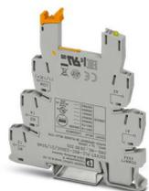
Module de base PLC de 6,2 mm contre les courants ou tensions parasites côté commande, avec raccordement vissé, sans relais ni relais à semi-conducteurs, pour montage sur profilé NS 35/7,5, avec filtre RCZ intégré, 1 contact inverseur, tension d'entrée : 230 V AC
