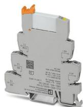
PLC-INTERFACE, comprenant un module de base PLC-BSC.../21 avec raccordement vissé et relais miniature enfichable à contact doré multicouche, pour montage sur profilé NS 35/7,5, 1 contact inverseur, tension d'entrée 60 V DC
