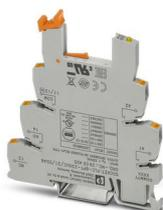
Module de base PLC de 6,2 mm contre les courants ou tensions parasites côté commande, avec raccordement Push-in, sans relais ni relais à semi-conducteurs, pour montage sur profilé NS 35/7,5, avec filtre RCZ intégré, 1 contact inverseur, tension d'entrée : 230 V AC
