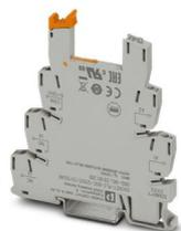
Module de base PLC de 6,2 mm contre les courants ou tensions parasites côté commande, avec raccordement vissé, sans relais ni relais à semi-conducteurs, pour montage sur profilé NS 35/7,5, avec filtre RCZ intégré, 1 contact inverseur, tension d'entrée : 120 V AC
