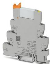
PLC-INTERFACE, comprenant un module de base PLC-BSC.../21 avec raccordement vissé et relais miniature enfichable à contact doré multicouche, pour montage sur profilé NS 35/7,5, 1 contact inverseur, tension d'entrée 48 V DC
