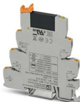
Interface PLC, comprenant le module de base PLC-BPT.../21 avec raccordement Push-in et relais à semi-conducteurs miniature enfichable, pour montage sur profilé NS 35/7,5, 1 contact NO, entrée : 60 V DC, sortie : 3-48 V DC/100 mA
