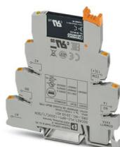
PLC-INTERFACE pour fonctions d'entrée, comprenant un module de base PLC-BPT.../SEN avec raccordement Push-in et relais à semi-conducteurs miniature enfichable, pour montage sur profilé NS 35/7,5, 1 contact NO, entrée : 120 V AC / 110 V DC, sortie : 3-48 V DC/100 mA
