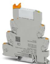
PLC-INTERFACE, comprenant le module de base PLC-BPT.../21 avec raccordement Push-in et relais miniature enfichable à contact doré multicouche, pour montage sur profilé NS 35/7,5, 1 contact inverseur, tension d'entrée 120 V AC/110 V DC
