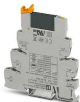
PLC-INTERFACE, comprenant un module de base PLC-BSC.../21 avec raccordement vissé et relais à semi-conducteurs miniature enfichable, pour montage sur profilé NS 35/7,5, 1 contact NO, entrée : 48 V DC, sortie : 3-48 V DC/100 mA
