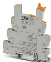
Module de base PLC de 6,2 mm contre les courants ou tensions parasites côté commande, avec raccordement Push-in, sans relais ni relais à semi-conducteurs, avec répartition de la tension d'alimentation de capteur (BB), 1 contact NO, tension d'entrée : 120 V AC
