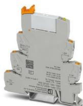
PLC-INTERFACE, comprenant un module de base PLC-BPT.../21 avec raccordement Push-in et relais miniature enfichable à contact doré multicouche, pour montage sur profilé NS 35/7,5, 1 contact inverseur, tension d'entrée 60 V DC
