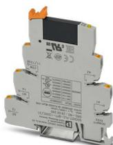
Interface PLC, comprenant le module de base PLC-BPT.../21 avec raccordement Push-in et relais à semi-conducteurs miniature enfichable, pour montage sur profilé NS 35/7,5, 1 contact NO, entrée : 120 V AC/110 V DC, sortie : 3-48 V DC/100 mA
