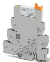
PLC-INTERFACE pour fonctions d'entrée comprenant un module de base PLC-BSC.../SEN avec raccordement vissé et relais miniature enfichable à contact doré multicouche, pour montage sur profilé NS 35/7,5, 1 contact NO, tension d'entrée 120 V AC/110 V DC
