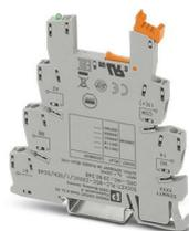
Module de base PLC de 6,2 mm contre les courants ou tensions parasites côté commande, avec raccordement vissé, sans relais ni relais à semi-conducteurs, avec répartition de la tension d'alimentation de capteur (BB), 1 contact NO, tension d'entrée : 230 V AC
