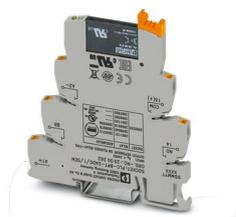
PLC-INTERFACE pour fonctions d'entrée, comprenant un module de base PLC-BPT.../SEN avec raccordement Push-in et relais à semi-conducteurs miniature enfichable, pour montage sur profilé NS 35/7,5, 1 contact NO, entrée : 24 V AC, sortie : 3-48 V DC/100 mA
