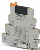
Interface PLC, comprenant le module de base PLC-BPT.../21 avec raccordement Push-in et relais à semi-conducteurs miniature enfichable, pour montage sur profilé NS 35/7,5, 1 contact NO, entrée : 48 V DC, sortie : 3-48 V DC/100 mA
