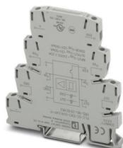
PLC-INTERFACE pour les applications NAMUR, comprenant le bloc de jonction de base PLC-BSC.../21 avec raccordement vissé et câblage intégré, pour montage sur rail DIN NS 35/7,5, sortie à commutation positive, tension d'alimentation 24 V DC
