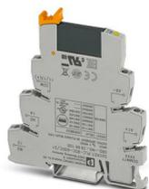
PLC-INTERFACE, comprenant un module de base PLC-BSC.../21 avec raccordement vissé et relais à semi-conducteurs miniature enfichable, pour montage sur profilé NS 35/7,5, 1 contact NO, entrée : 60 V DC, sortie : 3-48 V DC/100 mA
