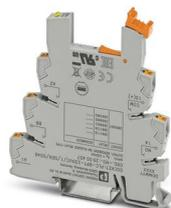
Module de base PLC de 6,2 mm contre les courants ou tensions parasites côté commande, avec raccordement Push-in, sans relais ni relais à semi-conducteurs, avec répartition de la tension d'alimentation de capteur (BB), 1 contact NO, tension d'entrée : 230 V AC
