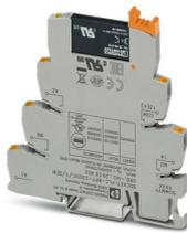
PLC-INTERFACE pour fonctions d'entrée, comprenant un module de base PLC-BPT.../SEN avec raccordement Push-in et relais à semi-conducteurs miniature enfichable, pour montage sur profilé NS 35/7,5, 1 contact NO, entrée : 230 V AC / 220 V DC, sortie : 3-48 V DC/100 mA
