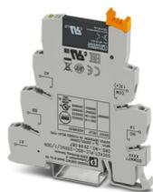
PLC-INTERFACE pour fonctions d'entrée, comprenant un module de base PLC-BSC.../SEN avec raccordement vissé et relais à semi-conducteurs miniature enfichable, pour montage sur profilé NS 35/7,5, 1 contact NO, entrée : 230 V AC/220 V DC, sortie : 3-48 V DC/100 mA
