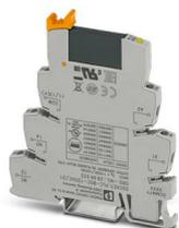
PLC-INTERFACE, comprenant un module de base PLC-BSC.../21 avec raccordement vissé et relais à semi-conducteurs miniature enfichable, pour montage sur profilé NS 35/7,5, 1 contact NO, entrée : 120 V AC/110 V DC, sortie : 3-48 V DC/100 mA
