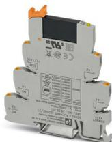
Interface PLC, comprenant le module de base PLC-BPT.../21 avec raccordement Push-in et relais à semi-conducteurs miniature enfichable, pour montage sur profilé NS 35/7,5, 1 contact NO, entrée : 230 V AC/220 V DC, sortie : 3-48 V DC/100 mA
