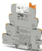
PLC-INTERFACE pour fonctions d'entrée comprenant un module de base PLC-BPT.../SEN avec raccordement Push-in et relais miniature enfichable à contact doré multicouche, pour montage sur profilé NS 35/7,5, 1 contact NO, tension d'entrée 230 V AC/220 V DC
