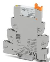
PLC-INTERFACE pour fonctions d'entrée comprenant un module de base PLC-BSC.../SEN avec raccordement vissé et relais miniature enfichable à contact doré multicouche, pour montage sur profilé NS 35/7,5, 1 contact NO, tension d'entrée 24 V DC
