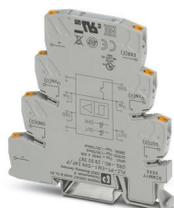
PLC-INTERFACE pour les applications NAMUR, comprenant le bloc de jonction de base PLC-BPT.../21 avec raccordement Push-in et câblage intégré, pour montage sur rail DIN NS 35/7,5, sortie à commutation positive, tension d'alimentation 24 V DC
