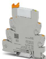
PLC-INTERFACE, comprenant un module de base PLC-BPT.../21 avec raccordement Push-in et relais miniature enfichable à contact doré multicouche, pour montage sur profilé NS 35/7,5, 1 contact inverseur, tension d'entrée 12 V DC
