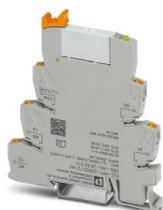
Interface PLC, comprenant le module de base PLC-BPT.../21-21 avec raccordement Push-in et relais miniature enfichable à contact doré multicouche, pour montage sur profilé NS 35/7,5, 1 contact inverseur, tension d'entrée 230 V AC/220 V DC
