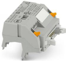
Adaptateur V8 pour 8 x PLC-INTERFACE (6,2 mm), automate: Câblage système API des cartes d'entrée, raccordement 1: IDC/FLK connecteur mâle 1x 14-pôles, raccordement 2: Raccord enfichable (Encliquetable sur les 8x blocs de jonction PLC-INTERFACE), raccordement 3: Raccordement vissé 1x 2-pôles, nombre de canaux: 8, logique de commande: minusschaltend
