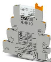
PLC-INTERFACE pour fonctions d'entrée comprenant un module de base PLC-BPT.../SEN avec raccordement Push-in et relais miniature enfichable à contact doré multicouche, pour montage sur profilé NS 35/7,5, 1 contact NO, tension d'entrée 24 V DC
