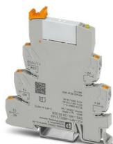
PLC-INTERFACE, comprenant un module de base PLC-BPT.../21 avec raccordement Push-in et relais miniature enfichable à contact doré multicouche, pour montage sur profilé NS 35/7,5, 1 contact inverseur, tension d'entrée 48 V DC
