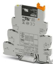
PLC-INTERFACE pour fonctions d'entrée, comprenant un module de base PLC-BSC.../SEN avec raccordement vissé et relais à semi-conducteurs miniature enfichable, pour montage sur profilé NS 35/7,5, 1 contact NO, entrée : 120 V AC/110 V DC, sortie : 3-48 V DC/100 mA
