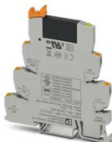
Interface PLC, comprenant le module de base PLC-BPT.../21 avec raccordement Push-in et relais à semi-conducteurs miniature enfichable, pour montage sur profilé NS 35/7,5, 1 contact NO, entrée : 24 V DC, sortie : 3-48 V DC/100 mA
