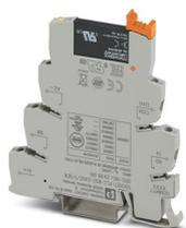
PLC-INTERFACE pour fonctions d'entrée, comprenant un module de base PLC-BSC.../SEN avec raccordement vissé et relais à semi-conducteurs miniature enfichable, pour montage sur profilé NS 35/7,5, 1 contact NO, entrée : 24 V DC, sortie : 3-48 V DC/100 mA
