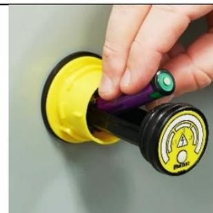
11. Installer la pile. Pour plus de détails, consulter la section Remplacement de la pile du présent manuel.
