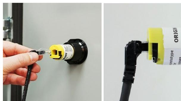
5. Insérer le connecteur à angle droit du câble système du VAT à l'arrière du module indicateur. Appuyer dessus fermement jusqu'à ce qu'il s'enclenche. Tirer ensuite sur le connecteur pour vérifier qu'il est bien enclenché.
