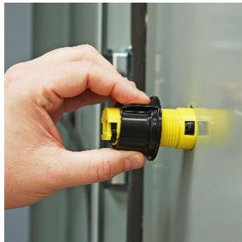
2. Monter l'écrou de tableau en orientant le collet vers la surface intérieure du tableau.
